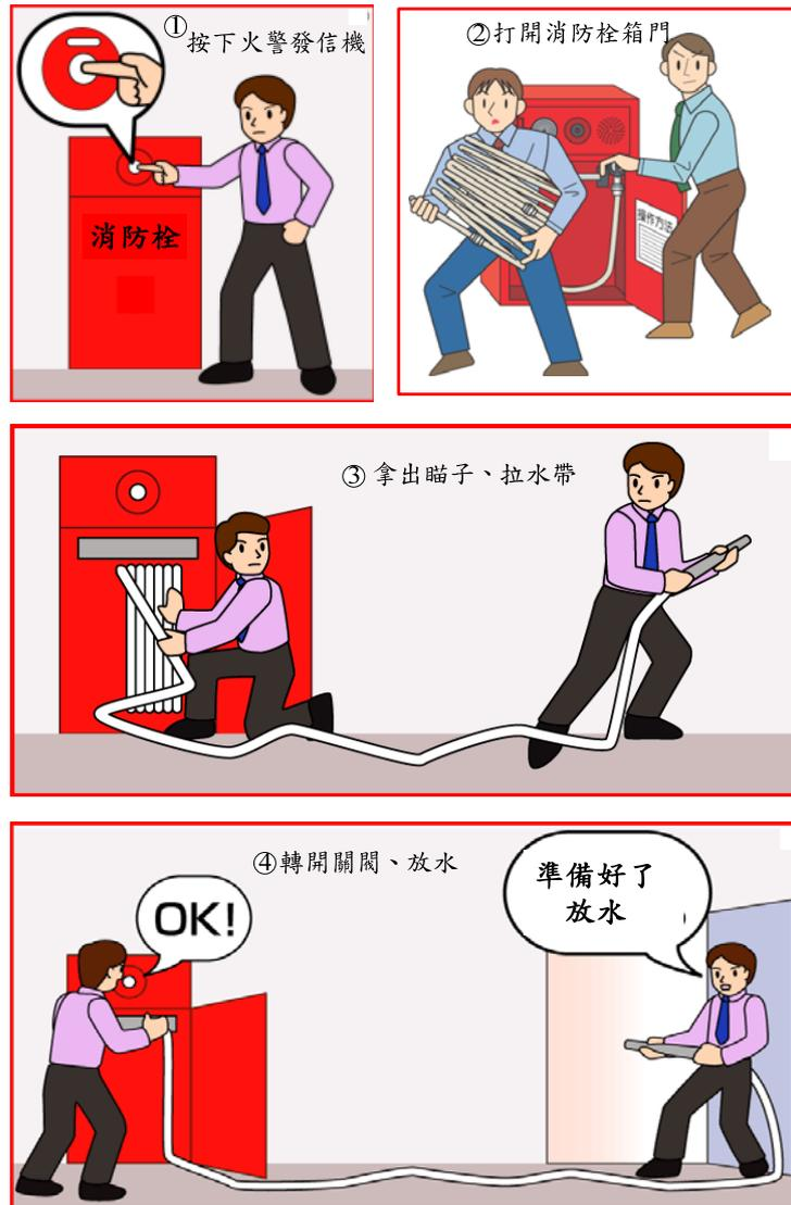
圖 2-21 第 1 種消防栓操作方法（資料來源：同註 1）
