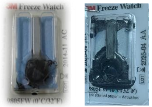
冷範凍監視片破裂、變色之範例
