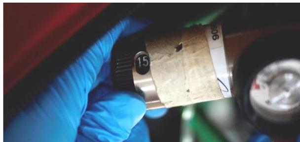
圖 5-3-10 調整流量至 15 l/min
