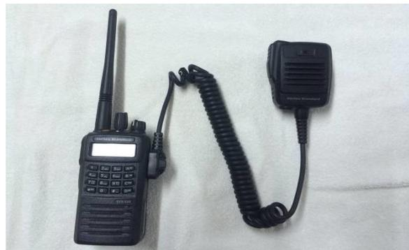
圖6-5-1 無線電基地台及發話麥克風 圖6-5-2 無線電手提台及手持麥克風
